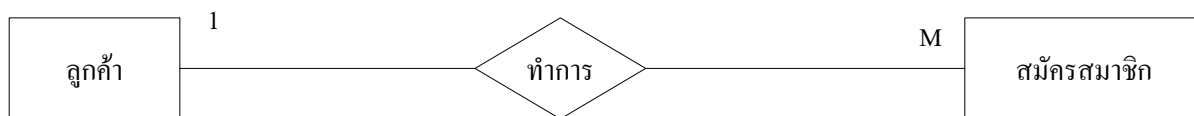
ภาพที่ 3-26 แสดงความสัมพันธ์ระหว่างเอนทิตี ลูกค้า และ การสมัครสมาชิก ลูกค้าหนึ่งคน สามารถทำการ สมัครสมาชิกได้หลายๆ ครั้ง
